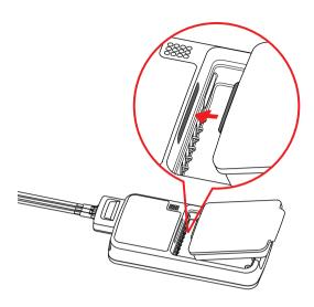
Drücken Sie das Akkugehäuse, wie durch den Pfeil in der folgenden Abbildung angezeigt, herunter, bis es einrastet.
