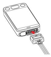
Stecken Sie den Stecker des EKG-Ableitungskabels, wie unten in der vergrößerten Abbildung dargestellt, in den EKG-Anschluss. Nachdem der Stecker des EKG-Ableitungskabels richtig in den EKG-Anschluss eingesteckt ist, sind die im Folgenden mit dem kleinen roten Kreis gekennzeichneten Teile nicht mehr sichtbar. Erste Schritte Vorbereitung
