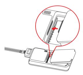
Drücken Sie den Akku, wie durch den Pfeil in der folgenden Abbildung angezeigt, herunter, bis er einrastet.
