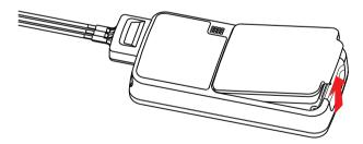
Entnehmen Sie den Lithium-lonen-Akku oder entfernen Sie die AA-Batterien aus dem Gehäuse.
